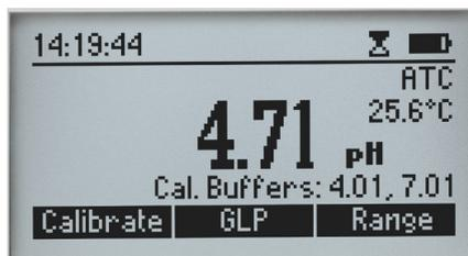
HI83314 est équipé d'une entrée type mini-jack permettant le branchement d'une électrode pH. Toutes nos électrodes pH numériques intelligentes avec connecteur mini-jack sont compatibles.
