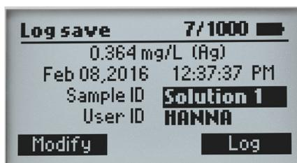
HI83314 peut mémoriser jusqu'à 1000 mesures photométriques et pH associées. À la mise en mémoire, l'utilisateur est invité à identifier l'échantillon et l'opérateur à l'aide du clavier alphanumérique. Les mesures enregistrées sont automatiquement complétées avec les données BPL (date, heure, valeurs des standards).
