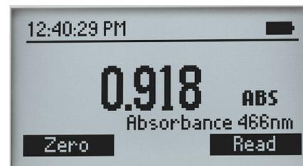
HI83314 dispose aussi d'une gamme de mesure d'absorbance avec 5 longueurs d'onde, offrant à l'utilisateur, qui le souhaite, la possibilité de personnaliser ses analyses et d'établir ses propres courbes d'étalonnage.
