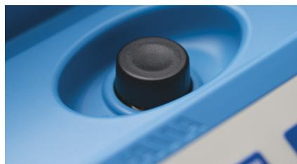
Le couvercle obturateur protège la cellule de mesure de toute intrusion de lumière parasite pouvant altérer la qualité et les résultats de mesure.
